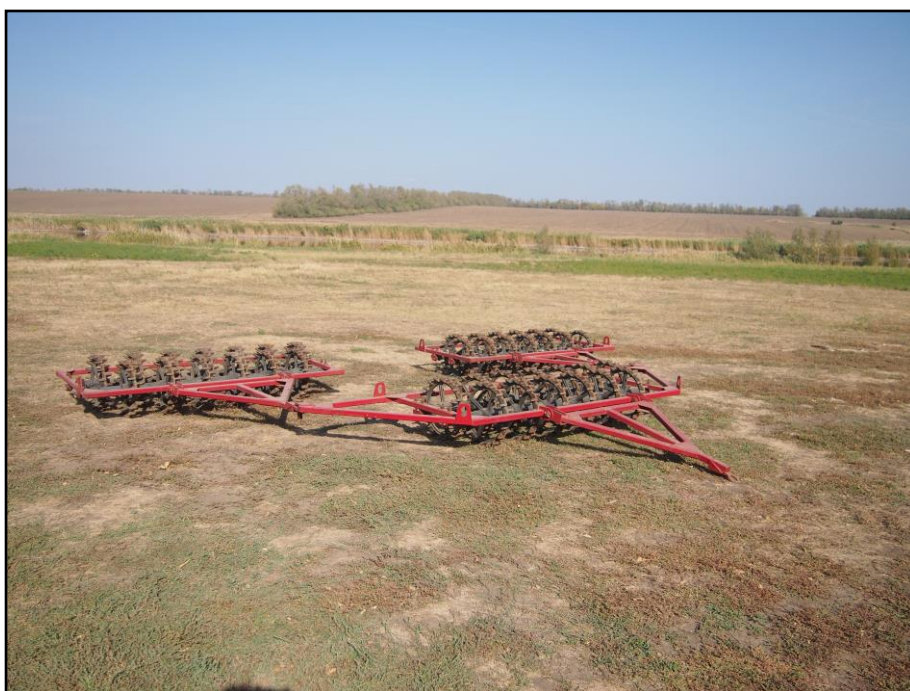
Каток кольчато-шпоровый прицепной 3-ККШП-6-02
