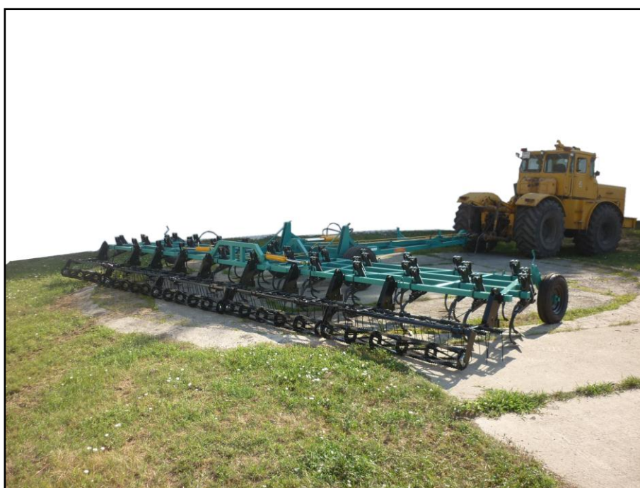
Рисунок 2 – Культиватор КСОП-12 в агрегате с трактором К-700А в рабочем положении. Вид спереди справа
