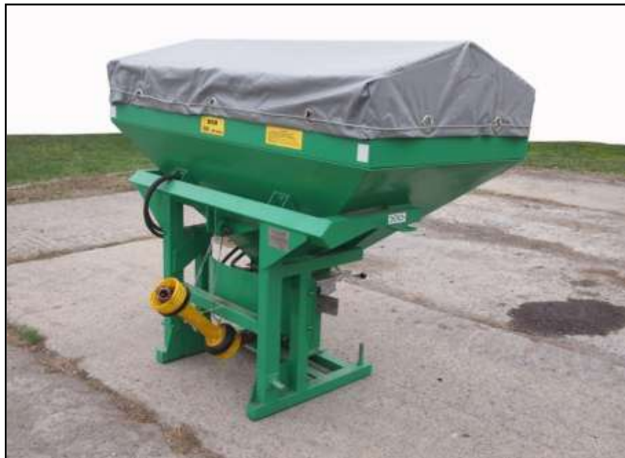
Рисунок 1 – Точный рассеиватель удобрений дисковый ТРУД-1Б. Вид спереди слева
