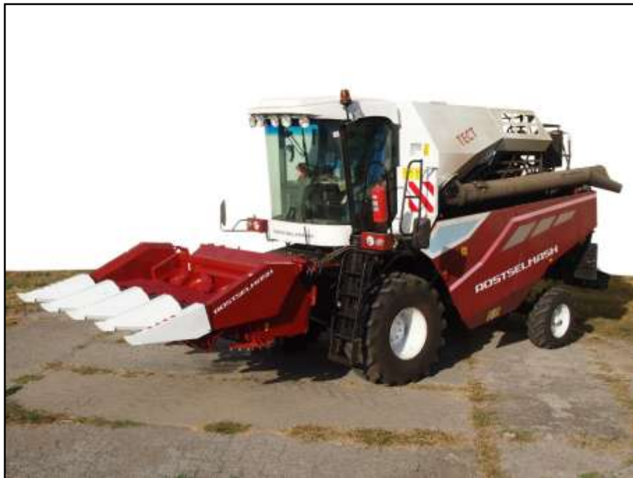
Рисунок 3 – Приспособление для уборки кукурузы ППК-41.51 в агрегате с зерноуборочным комбайном РСМ-083 в транспортном положении. Вид спереди слева
