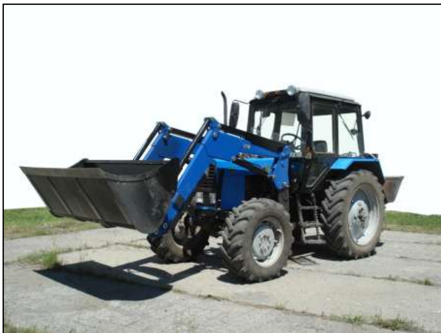
Рисунок 1 – Погрузчик универсальный КУН-2000-0.2, смонтированный на трактор Беларус 82.1, в транспортном положении. Вид спереди слева
