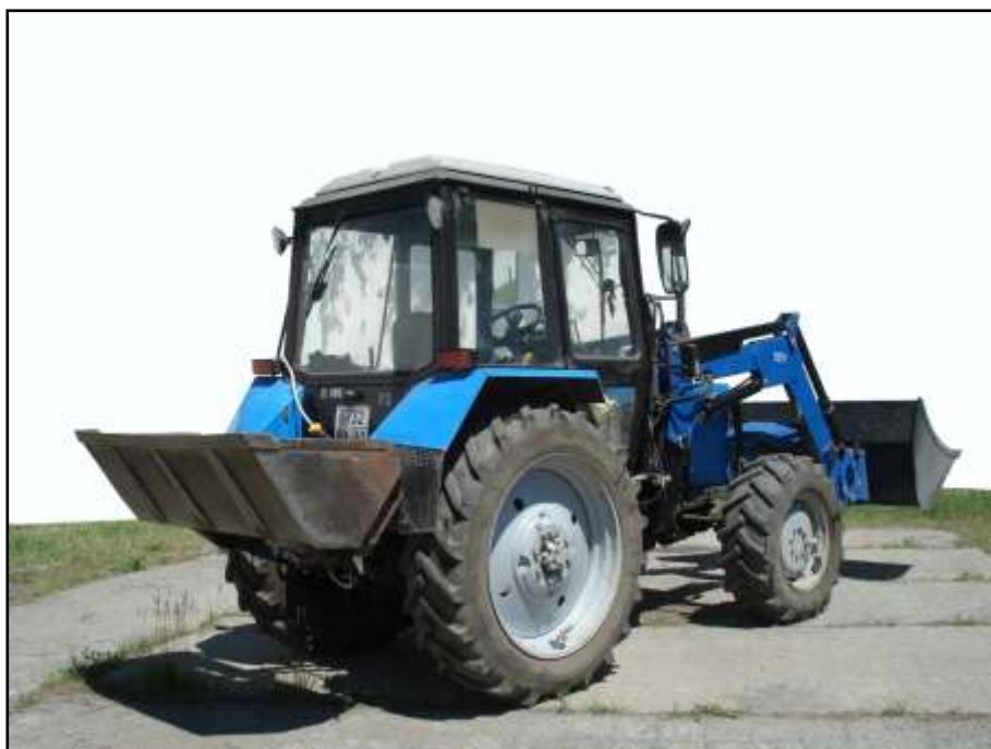
Рисунок 2 – Погрузчик универсальный КУН-2000-0.2, смонтированный на трактор Беларус 82.1, в транспортном положении. Вид сзади справа
